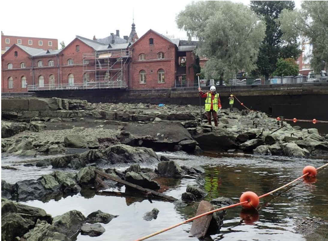
Kuva 2. Menetelmiin kuului mm. GNSS laitteella mittaaminen ja kuvaaminen. Kuvassa dokumentoidaan neulapadon perustusta. Kuvattu lännestä.
