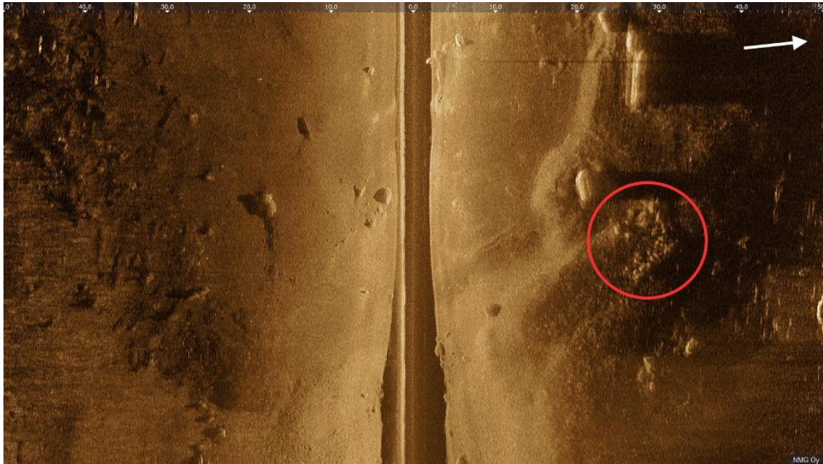
Kuva 11. Viistokaikuluotaukku kohteesta 1. Neliömäinen kivrakenne on todennäköisesti hirsiaarkun jäännös.
