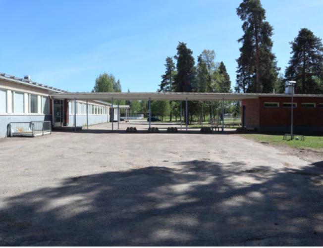
Juupajoen koulun alakoulurakennus on rakennettu 1960-luvun alussa. Julkisivumateriaalit ovat säilyneet alkuperäisinä: sekä sileät että aaltoprofiloitut mineriittilevyt, betonivalu kivijalassa sekä puhtaaksimuurattu punatiili.
