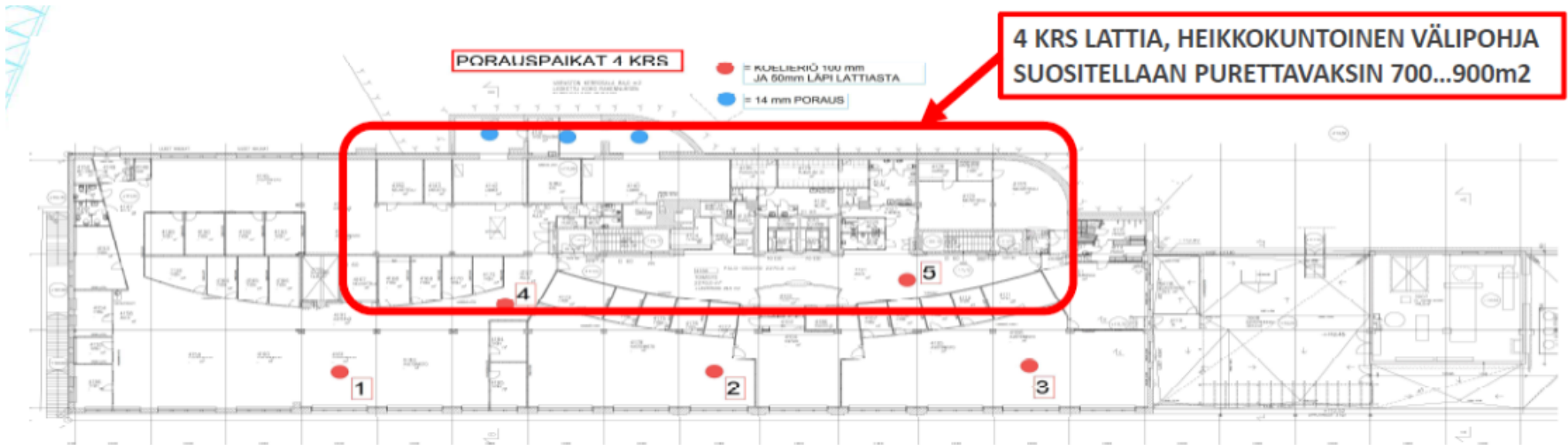
Kuva 81 4. kerroksen näytteiden tulokset (Kuntotutkimuksen yhteenveto TSO Rakennesuunnittelu Oy)
