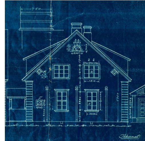
Piirrokset ja kuva: Kankarin koulu 1920-luvun suunnitelmissa ja 2019. Myöhempi julkisivuremontti on karsinut koulun klassismin piirteitä mm. nurkkapilasterit ja vuorilaudat.
