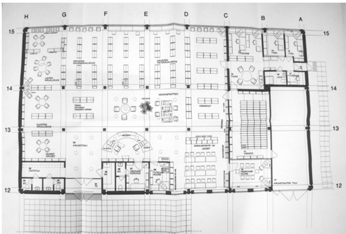
Kuva 4. Ruoveden kunnankirjaston pohjapiirustus peruskorjauksen yhteydessä. Sisäänkäynti kuvassa alhaalla vasemmalla, henkilökunnan tiloja oikealla entisessä asunto-osassa. Kirjastoauton halli oikealla alhaalla. (Ruoveden kunnankirjaston arkisto.)
