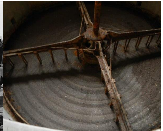
Lielahden tehtaan vedenpuhdistus perustui mekaaniseen hiekan läpi suodattamiseen. KUVA Kirsi Niukko/Kulttuuriympäristöpalvelut Heiskanen&Luoto Oy
