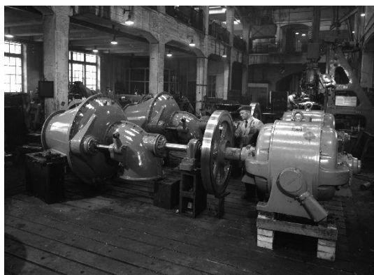
Kaksi Francis-kaksoisturbiinia vuonna 1951. Kuva on ilmeisesti nykyisen kokoelmavaraston tilasta (W1), taustalla kaarioviukot vanhaan konehalliin (W5).
