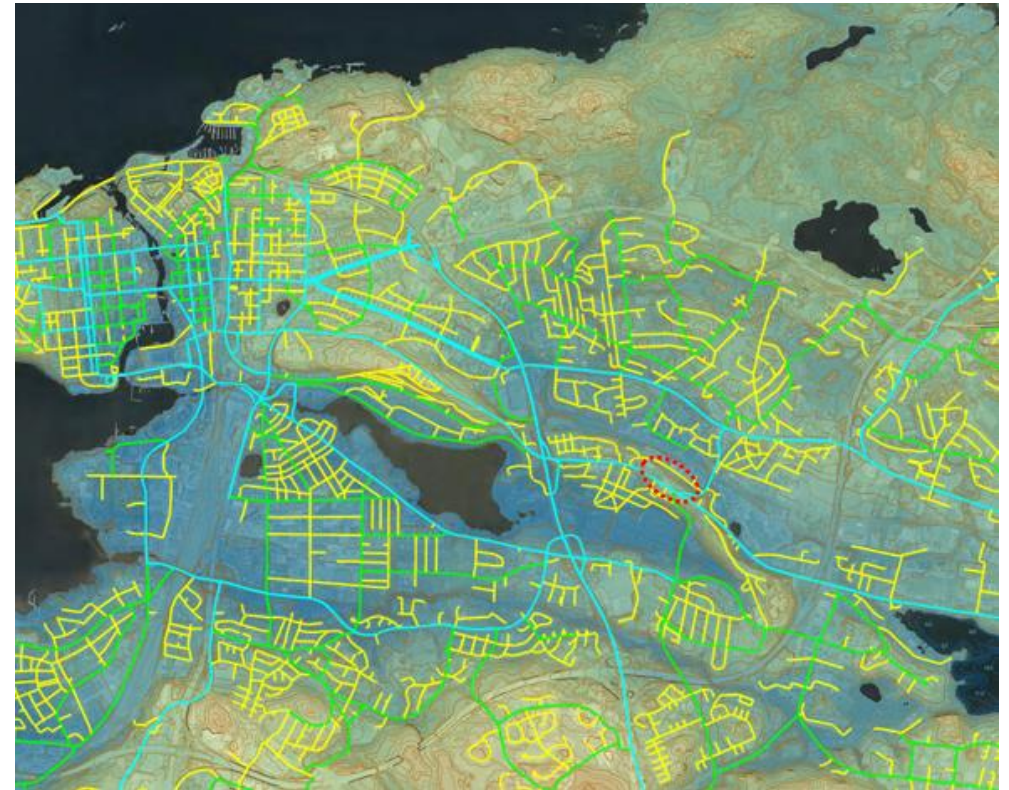
Kuva 45. Tampereen korkeusmalli (2 m) tuo hyvin esiin tarkastelualueen sijainnin Pyhäjärveltä Kaukajärvelle ulottuvan laakson halkaisevalla harjulla. Alavammat alueet on kuvattu sinisellä, ja selänneet sekä harjut kellertävällä. Pääkadut on esitetty korkeusmallin päällä turkoosilla sekä pienemmät kadut vihreällä ja keltaisella. Valtateitä ei ole esitetty kuvassa. Selvitysalueen likimääräinen sijainti on osoitettu punaisella katkoviivalla. (Tampereen kaupunki 2022)
