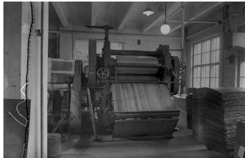
Alla: Näsijärven pahvitehtaan "Johann Kleinewerfers Söhne":n 1870-1895 Krefeldissä valmistama pahvikone. Pahvikonetehdas toimii edelleen, kts. www.kleinewerfers.de . Kuva: Tampereen Siiri valokuva-arkisto. .
