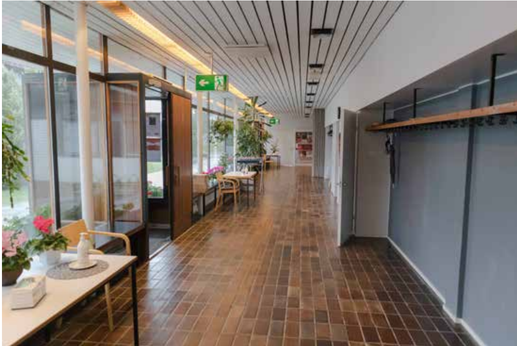
Lempoisten seurakuntatalo, Lempäälä (arkkitehti Erko Virkkunen, 1963). Aulatilassa on käytetty viimeistelyjä, pelkistettyjä yksityiskohtia ja laadukkaita materiaaleja. Niistä mainittakoon elävä punaruskeasävyinen klinkkerilattia ja sirot tammi-lasi-metallirakenteiset tuulikaapit. Kuva: Kerttu Loukusa 2021.
