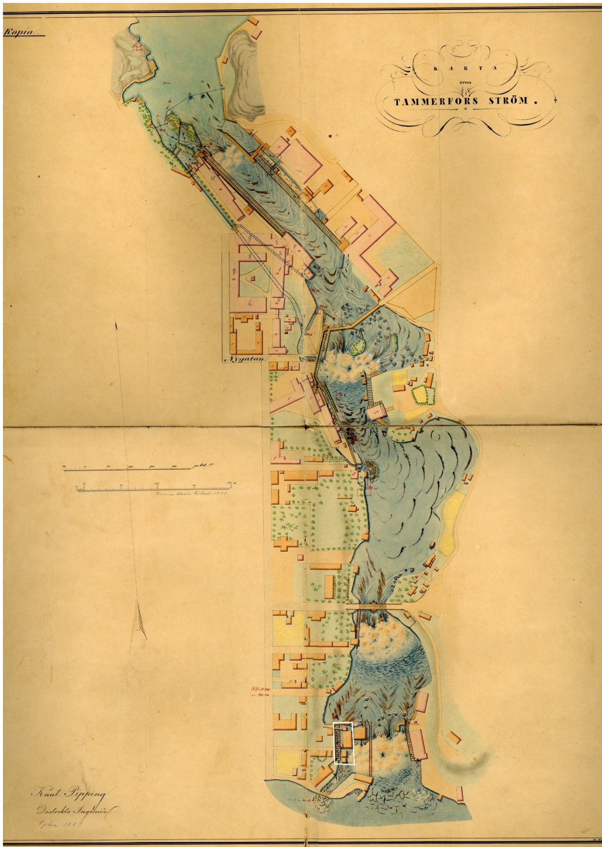
Tammerkosken kartta vuodelta 1867. Kuvan alaosassa näkyy ldestamin puuhiomo rakennuksineen. Hiomon rakennukset on rajattu valkoisella. Puuhiomo rakennettiin kosken päälle. Kuvasta on nähtävissä puurakennusten määrä Tampereen silloisessa kaupunkikuvassa. Keltaiset rakennukset ovat puuta, vaaleanpunaiset kiveä eli tiiltä. Suurin osa teollisuusrakennuksista oli jo kivirakennuksia. Kuva: Vapriikin kuva-arkisto.
