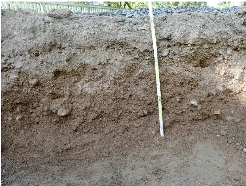
Kuva 14. Koekuoppa 4:n itäprofiili. Kuopassa havaittiin noin 60 cm paksun täyttökerroksen alapuolella luontainen maannos. Paikalta puuttui koekuopassa 2 havaittu peltokerros. Ilmeisesti paikalta puuttuu 1950-lukua vanhemmat ihmistoiminnan tuloksena syntyneet maakerrokset.
