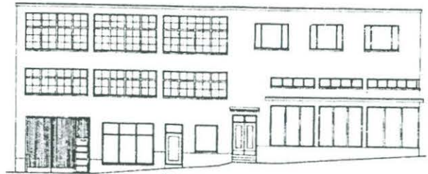
Julkisivu Ratinankujalle vuoden 1986 piirustuksissa. Alakerran ikkunajakoa ja kellarin ovi on muutettu ja ovikatokseen laitettu nimikilpi.
