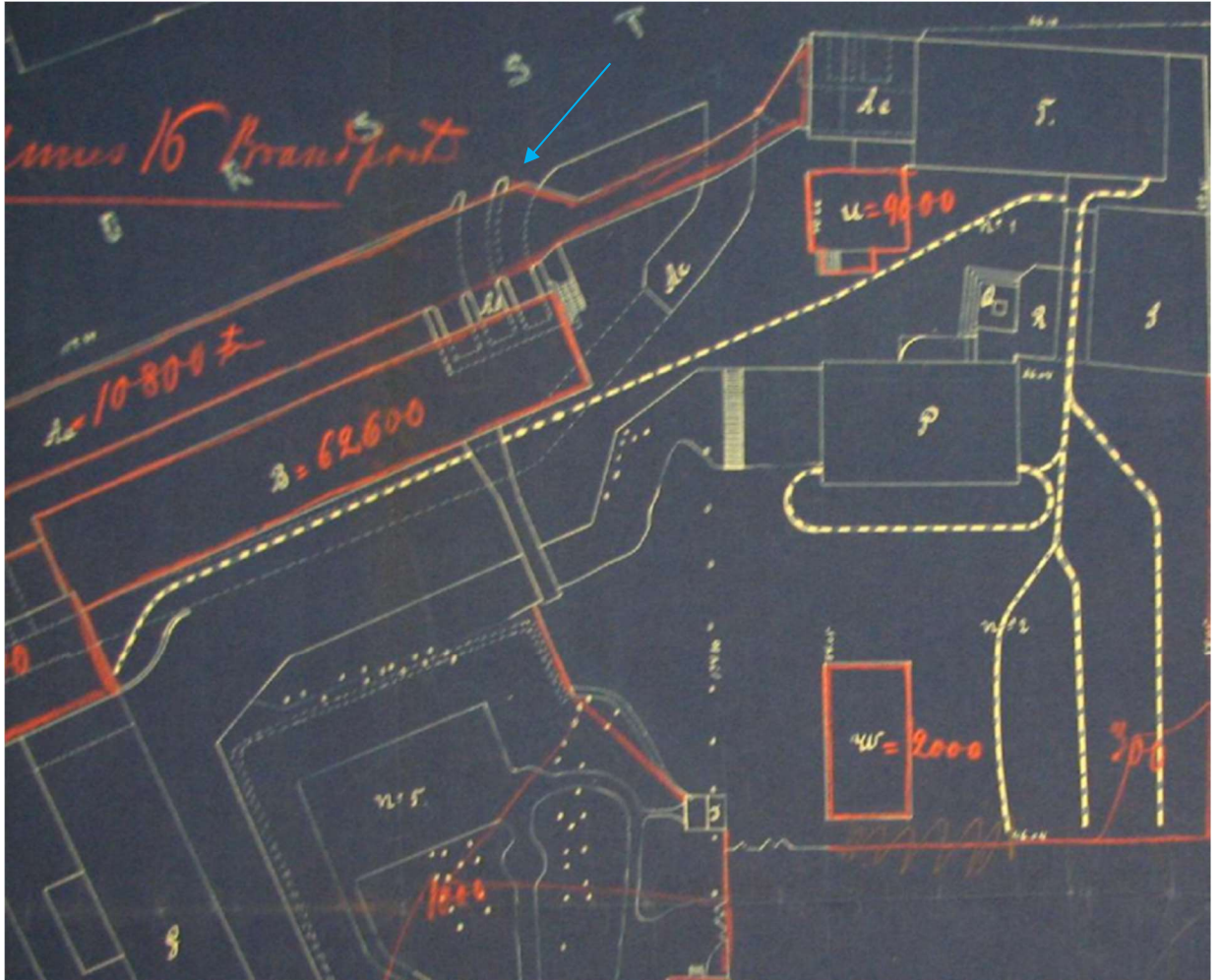
Kuva 14. Punaisella tehdyt merkinnät ovat päivätty lokakuulle 1908. Pohjakartassa näkyvä pannuhuonehuone (1905/07) on jo kuitenkin laajennettu nykyiseen kokoonsa, joten pohjakartta on todennäköisesti vuoden 1907 vaiheilta. Sähkölaitokseen liittyvät vanhimmat vedenohjausrakenteet on merkitty karttaan sinisellä nuolella. Kartan laatimisajankohdan jälkeen rakennetut rakenteet A1-A4 sijaitsevat sinisen nuolen ja kanavan suuaukon välisellä alueella. (Kartta: Frencellin järjestämätön piirustusarkisto, TKA.)
