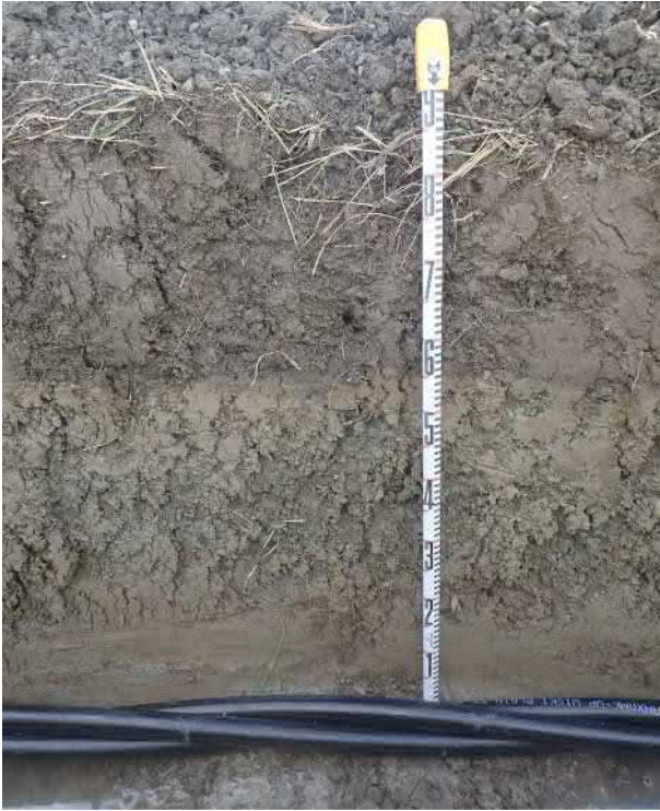
Peltoalueen maakerroksia kaapelikaivannon leikkauksessa. Ylinnä homogeeniseksi sekoittunut pelton muokkauskerros, sen alla puhdas savi.
