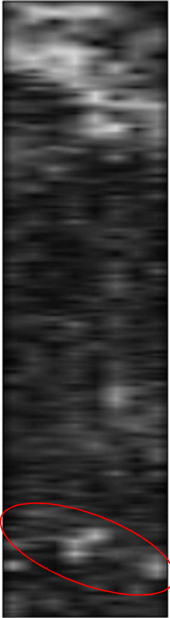
Kuva 7. Pannuhuonerakennuksen pohjoispuolella sijaitseva tutka-alue f tasossa - 35 cm maanpinnasta. Alueen pohjoisosassa erottuu useamman vierekkäin ja/tai päällekkäin kulkevan kaapelikaivannon aiheuttama anomalia. Alueen eteläosassa on heikompi, mahdollisesti vanhemman, jo käytöstä poistetun putki- tms. kaivannon aiheuttama anomalia (Vertaa tulkintakartat alueesta f).
