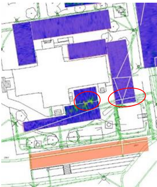
Kuvat 22-23. Maatutkausalueen h keskellä sekä alueen i eteläpäädyssä tasolla S70 ja S80 erottuvat ilmiöt ympyröity punaisella. Vasemmanpuoleisessa kuvassa kaupungin johtokartassa olevat putki- ja kaapelilinjat merkitty vihreällä, maatutkatuilla alueilla valkoisella viivalla.
