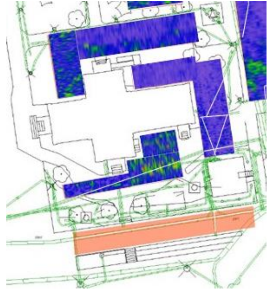
Kuvat 20-21. Kirkon piha-alueen maatutkausalueet tasolla S30 – S40, noin 35–50 cm nykyisen maan pinnan alapuolella. Alueilla erottuu useita voimakkaita ilmiöitä, jotka liittynevät alueella risteileviin putki- ja kaapelilinjoihin (kaupungin johtokartassa olevat putki- ja kaapelilinjat merkitty vihreällä, maatutkatuilla alueilla valkoisella viivalla).
