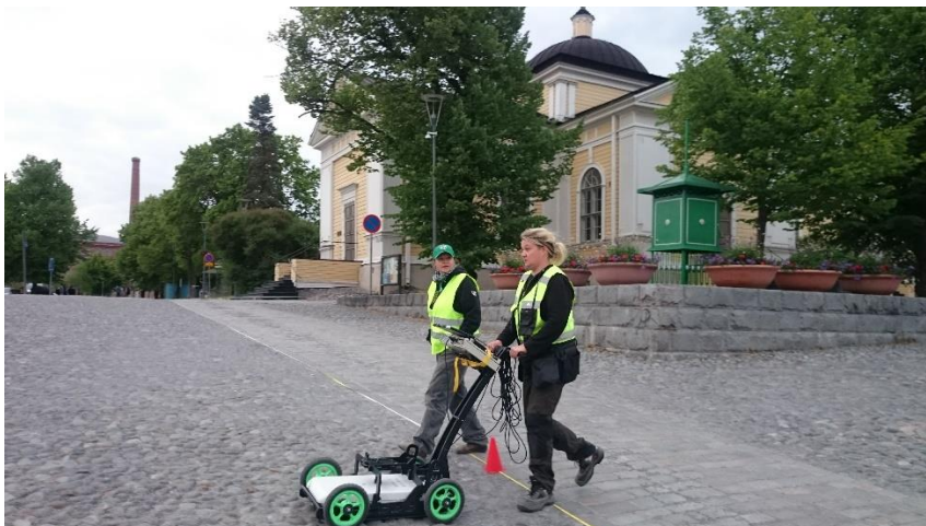
Kuva 3. Maatutkausta Keskustorin parkkialueen eteläosassa 18.6.2018. Kuva: Minna Seppänen.
