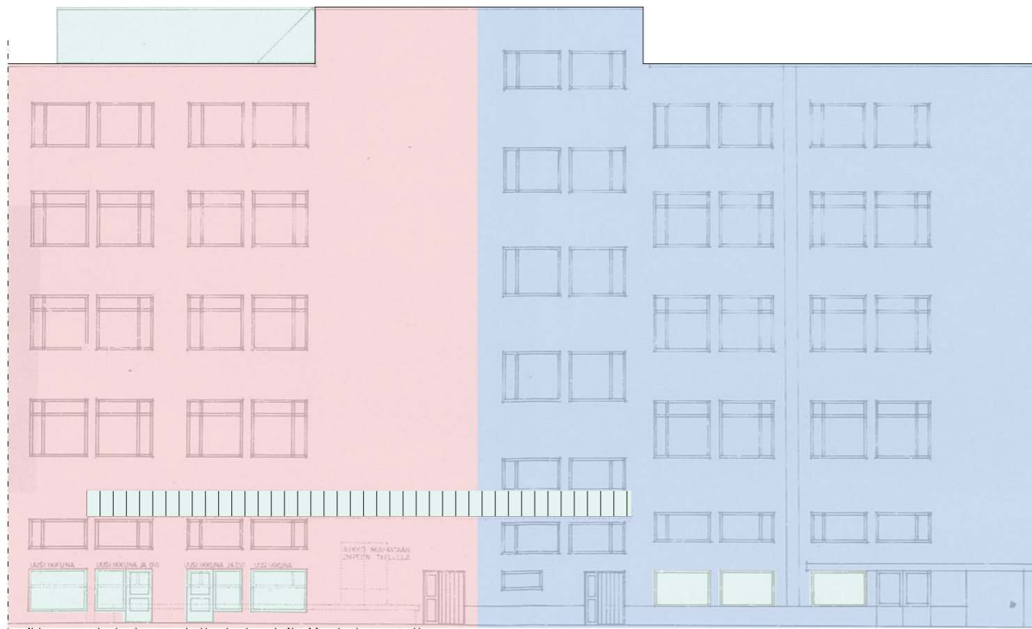
ikkuna-aukotusta muutettu, lastauslaituri ja -katos purettu JULKISIVU POHJOISEEN (SISÄPIHALLE)
