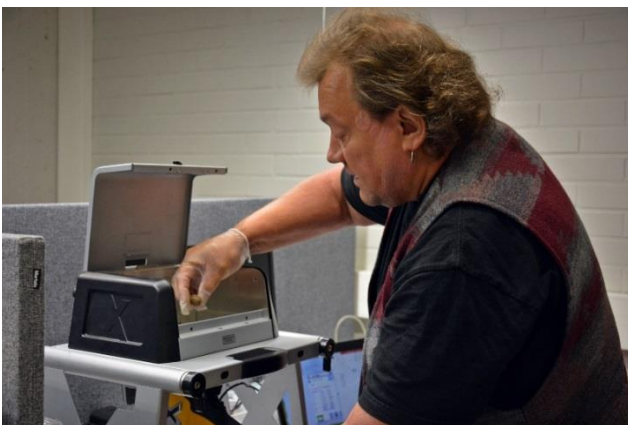
KYY 287: 65 Jussi Kinnunen tekee metalliesinelöydöistä pXRF-analysiä. Kuva: Ulla Moilanen
