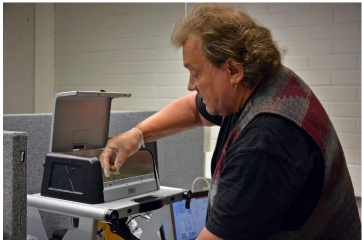
Kuva 51. Jussi Kinnunen tekee pXRF-analyysiä pienistä metalliesinelöydöistä. Kuva: Ulla Moilanen (KYY 287:65).
