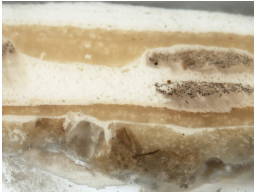
Näyte 8 ikkunan smyygi ala-aulan oikeanpuoleisesta ikkunasta. Näytteessä on vain valkoisia kerroksia ja lasikuitukankaan kuituja.
