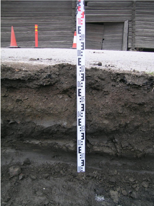
Kuva 9. E-v-alueen kaakkoisprofiilia: tiepenkereen soraa ja sen alla sekoittunutta savimultaa. Taustalla Kaipilan hirsinavetta. Kuvaaja: Sami Raninen. KY 130: 29.
