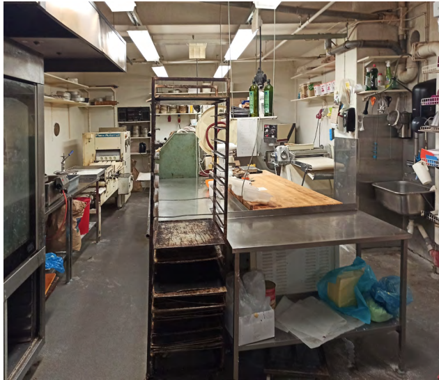
Tila 003 on Pullapuoti Wileniuksen leipomotila. Ulkoseinän (vas.) edessä on kevytrakenteinen levyseinä. Tilassa on massalattia.
