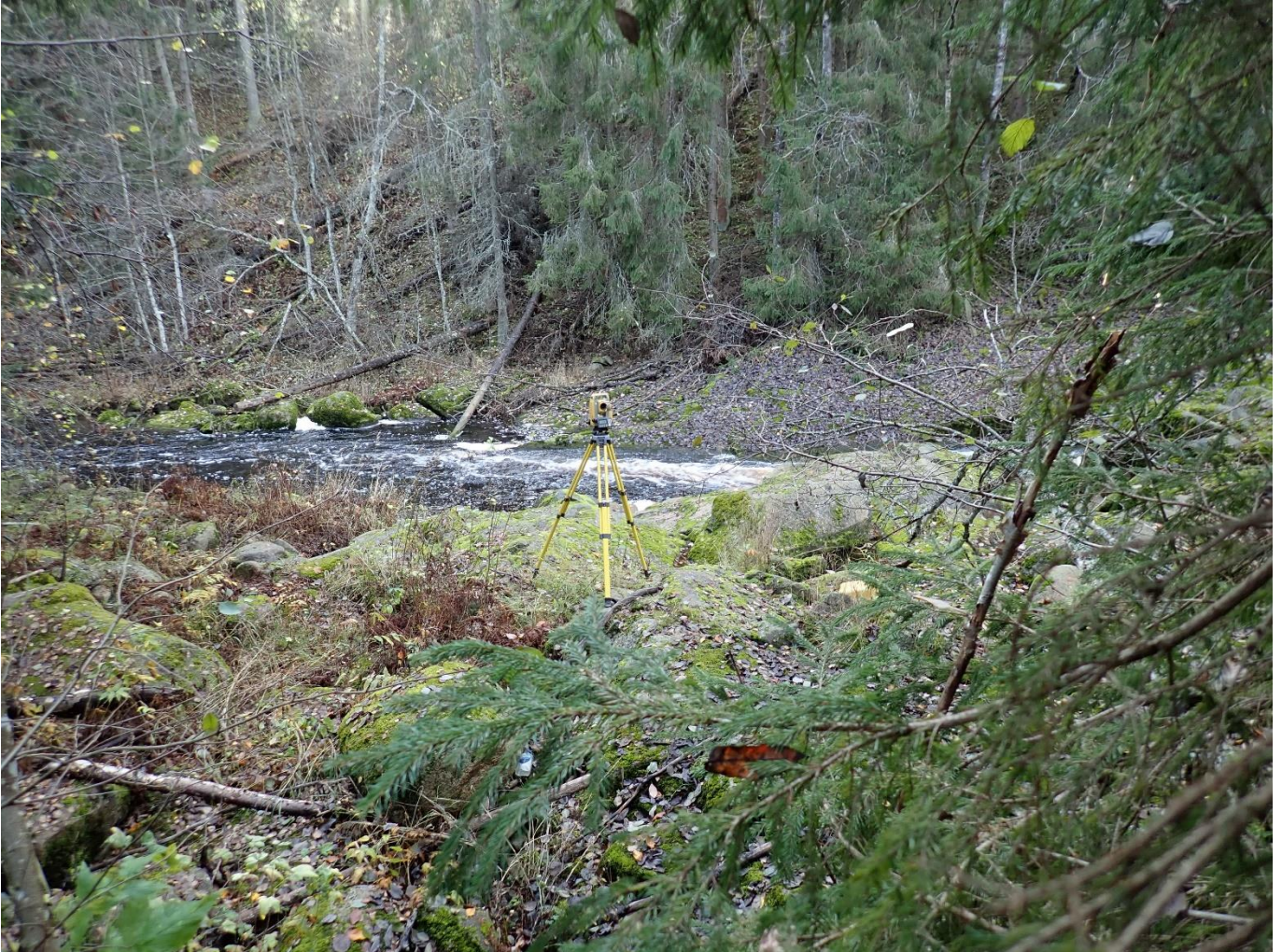
Kuva 1. Dokumentointi tehtiin TopCVon Easystation takymetrillä.
