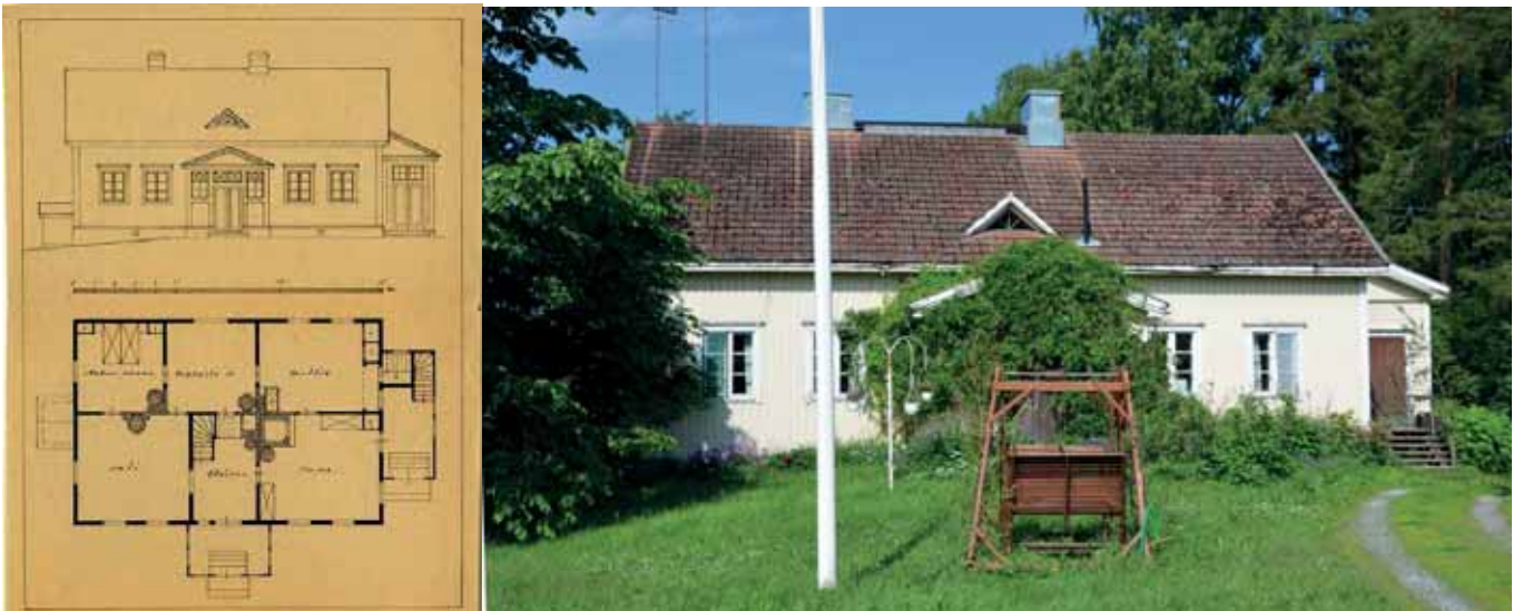
Kuvat: Kärjen talon julkisivu- ja 1. krs. pohjapiirros. Talossa säilytettävien piirustusten tekijää ei tunneta. Ulkoasusta päätellen kyseessä ovat tyyppi- ja mallipiirustukset, joita julkaistiin 1900-luvun alkupuolella useita valtion, lehtien, suunnittelijoiden tai maatalousseurojen toimesta.
